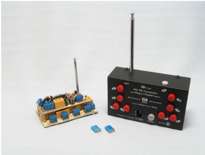
T100 無線遙控發射器、R100 接收器 及 TX/RX 配對晶體 (分 10 個頻道)
