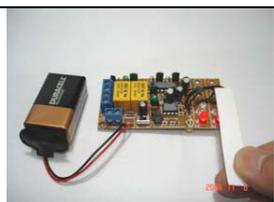
3. 剪取一塊闊約 10mm 的白色紙條，如上圖般遮蓋著 LED 及光敏二極管，聽到繼電器發出"的"一聲（繼電器啓動聲音），拿開紙條亦聽到"的"一聲（繼電器復位聲音），這證明當光電感應器遇白色時繼電器啓動，當遇黑時繼電器復位。如是者檢查另一邊的感應器。
